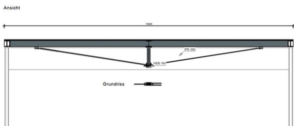
Poutre métallique sous-tendue d'une portée de 16 mètres
