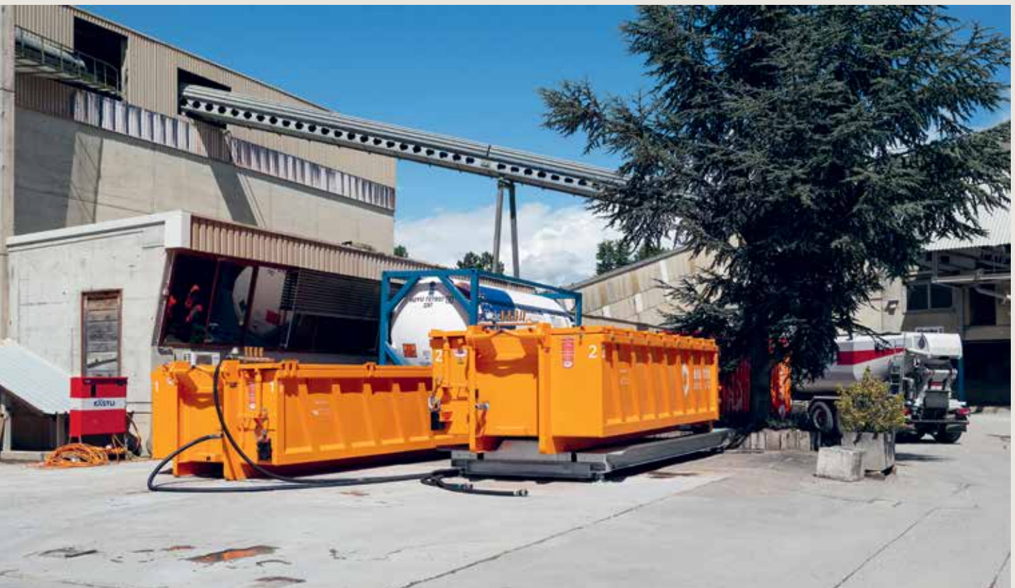
Die Firma neustark verwendet zur Herstellung von Beton statt Kies ein Granulat aus Abbruchbeton, das mit CO 2 angereichert wurde.
