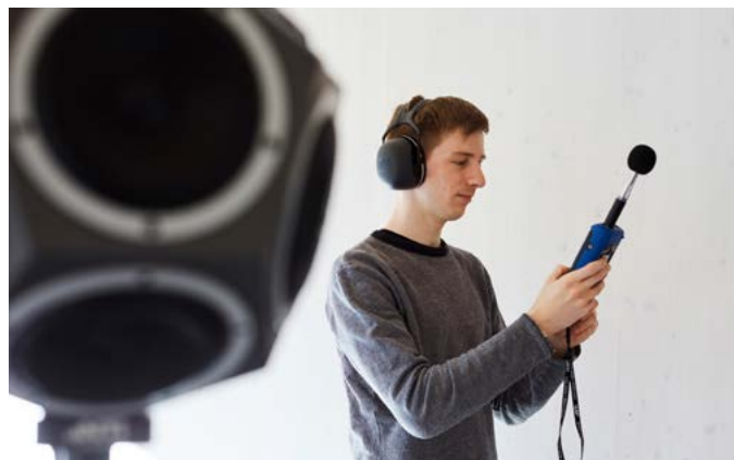
Dem akustischen Verhalten von Holzbaukonstruktionen auf der Spur: Schallmessung in einem Holz-Mehrfamilienhaus in Bümpliz.
