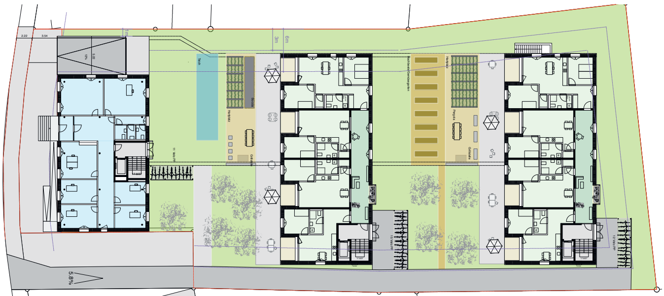
Die Geometrie der Parzelle führte zu einem Konzept mit drei gestaffelten Baukörpern.
